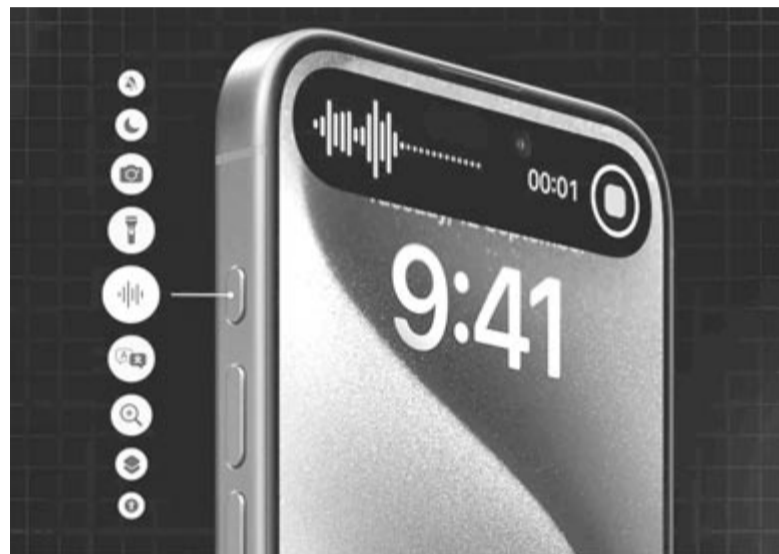
A programozható gomb, ami a némítókapcsolót váltotta
